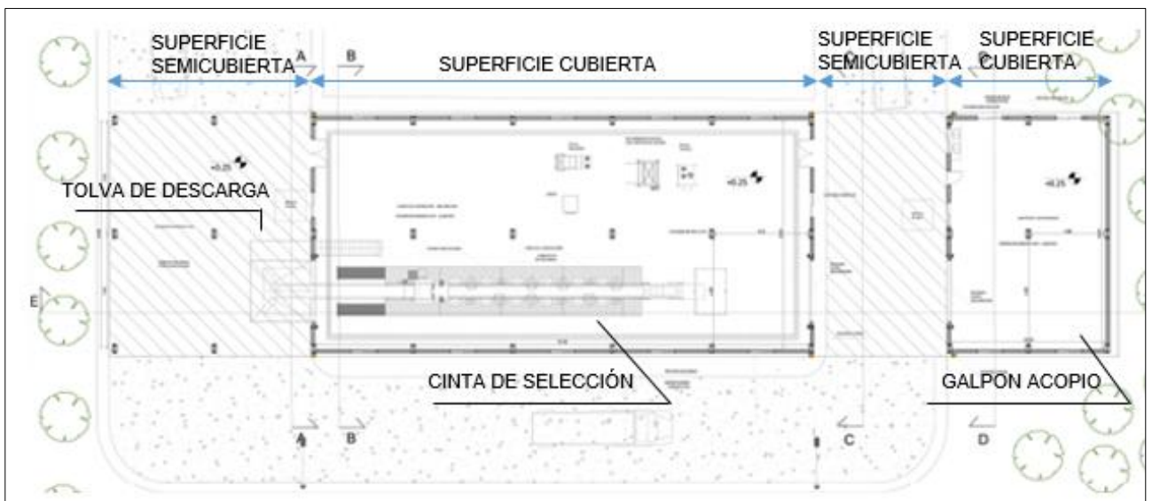
Figura 28: Planimetría tipo de PSyA (cap.3 tn/h)
